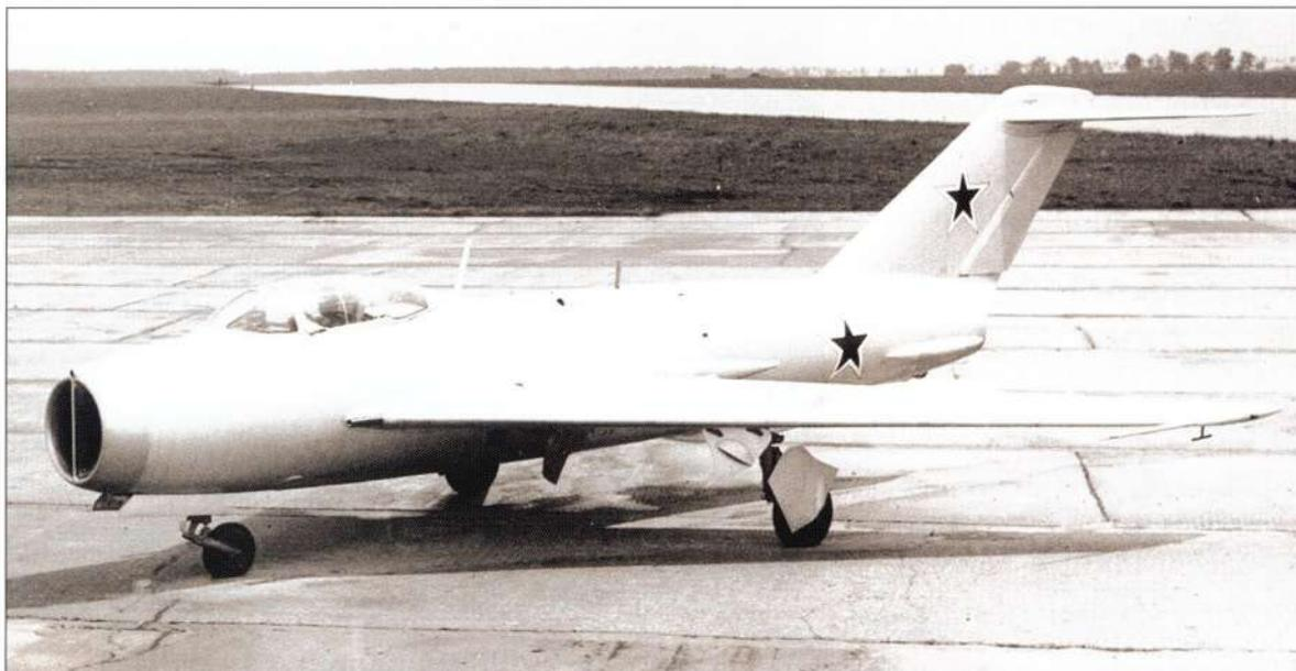
Опытный истребитель И-360 (СМ-2) имел крыло с углом стреловидности 57 градусов и оснащался двумя двигателями. Первоначально его горизонтальное оперение размещалось на киле, как у истребителей МиГ-15 и МиГ-17
