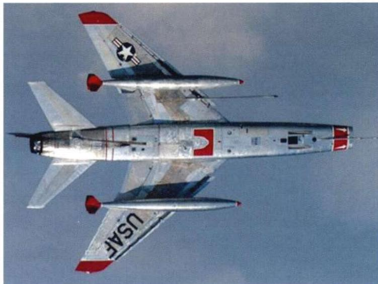
**Истребитель-бомбардировщик F-100D с новым крылом. Элероны отодвинуты ближе к законцовкам, а между ними и фюзеляжем появились небольшие закрылки**
