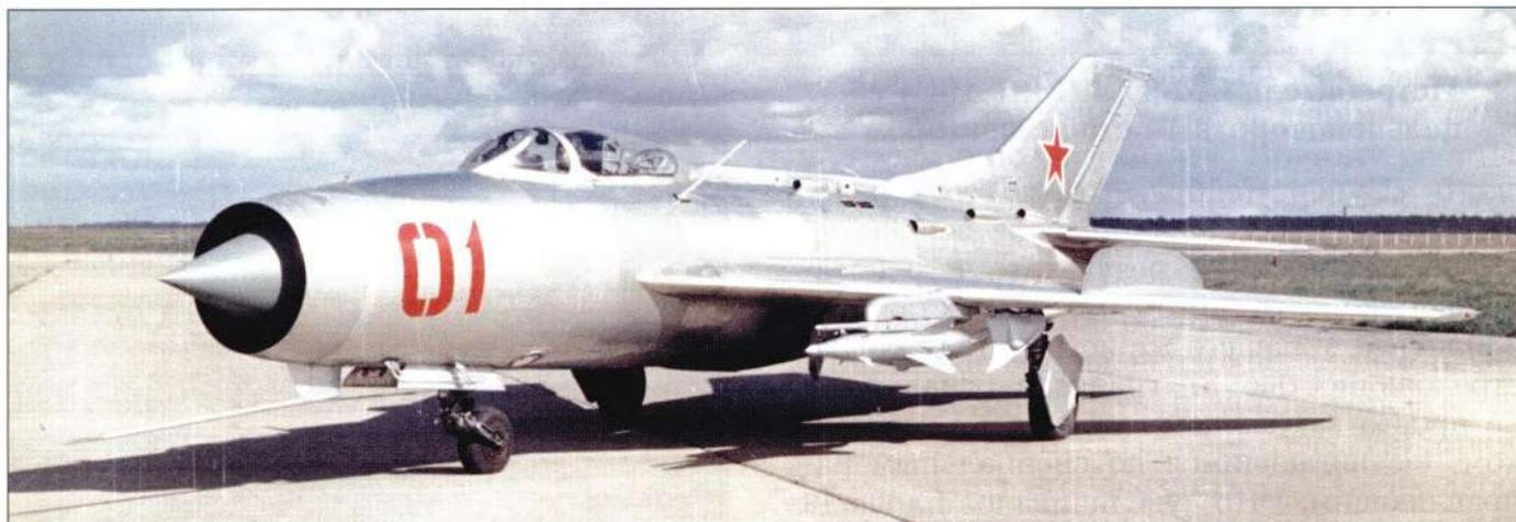
**Опытный истребитель-перехватчик СМ-12ПМ, оснащенный бортовым радиолокатором в носовом конусе воздухозаборника**
