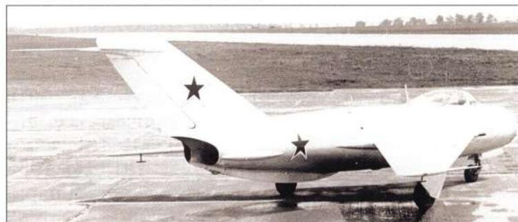
все эти проблемы. В частности, стабилизатор, изначально установленный на киле, пришлось перенести на фюзеляж. Тогда же ученые-аэродинамики пришли к решению заменить стабилизатор с рулем высоты на цельноповоротное горизонтальное оперение. Конечно, на опытных СМ-2 это делать не стали, но такое решение было впоследствии реализовано на серийных истребителях МиГ-19.
