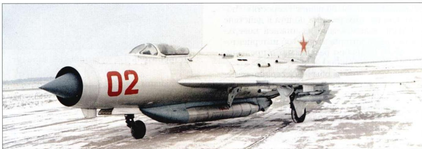
**Опытный истребитель-перехватчик СМ-12ПМУ с дополнительным подвесным ракетным ускорителем**
