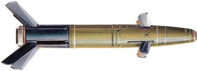
**Снаряд «Краснополь» с раскрытыми аэродинамическими рулями и уже без носового сбрасываемого обтекателя системы наведения**
