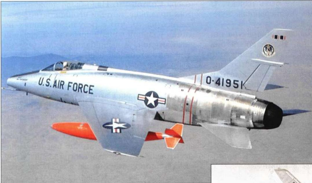
**В полете усовершенствованный истребитель-бомбардировщик F-100С. Обратите внимание на то, что на крыле самолета все еще отсутствуют закрылки. Их место занимают большие двухсекционные элероны**
